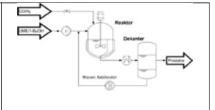
Temperaturgesteuerte Mehrkomponentenlösungsmittelsysteme (TML) sind eine elegante Möglichkeit, homogene Katalysatoren vom Produkt abzutrennen und so zu rezyklieren. Im vorliegenden Beitrag wird die Entwicklung der TML vom Labor- in den kontinuierlichen Miniplant-Maßstab beschrieben und anhand von Beispielen genauer beleuchtet.
